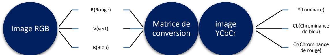
*Figure II-1 : schéma de conversion RVB en YCbCr [14]*
